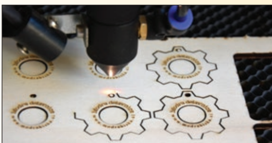
Laserski gravirni stroj v akciji
