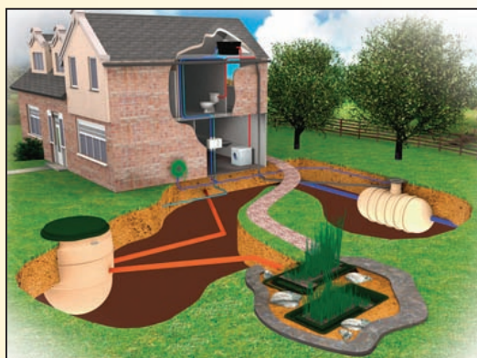
Netipska MKČN - odvajanje odpadne vode preko pretočne greznice v rastlinsko ČN
