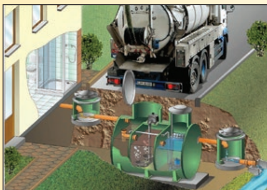
Pravilna vgradnja tipske MKČN
